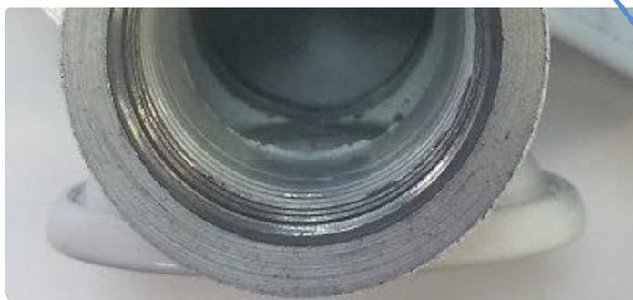
1. Заглушка из стали не имеет антикоррозионной защиты и нано-полимерной мембраны и, как следствие, - подвержена коррозии с последующей протечкой радиатора
