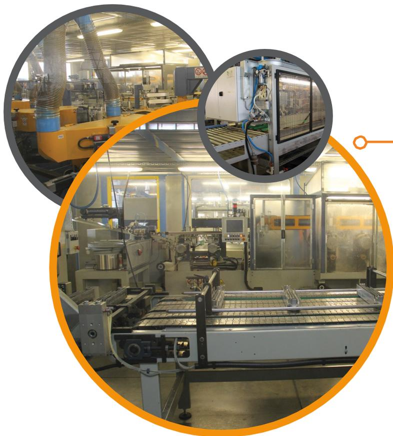
Многоступенчатая обработка секций радиаторов, шлифовка торцов, накатка резьбы и последующая сборка отдельных секций в радиаторы с заданным количеством секций производится на машине последнего поколения револьверного типа GI-Zeta (Италия).
