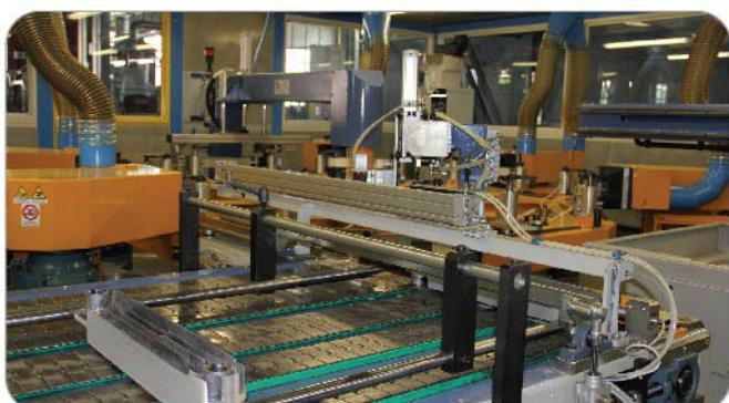
Отлитые секции поступают на линию механической обработки и сборки при 100% проверке на герметичность давлением 30 bar.
