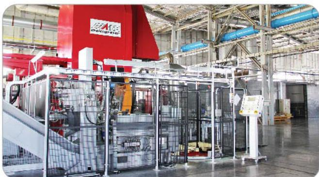
Сердце предприятия – его литейный комплекс. Все операции, начиная с подготовки расплава, вплоть до укладки отливок на паллеты происходят в полностью автоматическом режиме.
