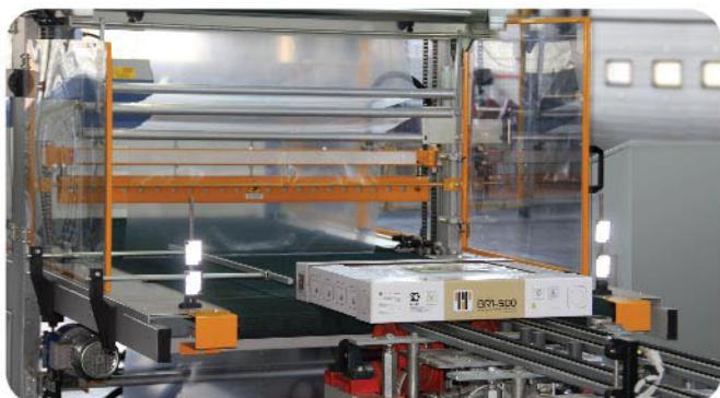
Финальным этапом производства является упаковка готового изделия в два слоя термоусадочной пленки с использованием защитных картонных боковин.
