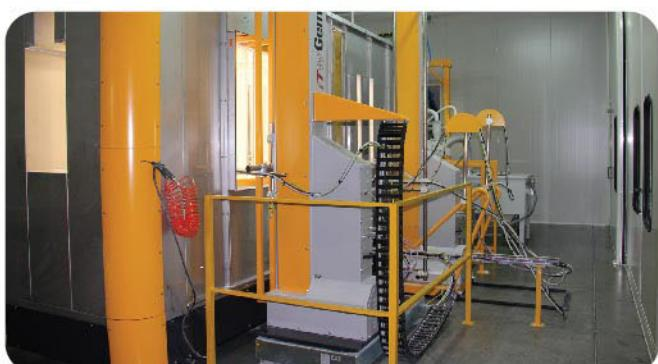
Покраска приборов производится методом электростатического напыления. Технология обеспечивает долговечное, износостойкое покрытие.
